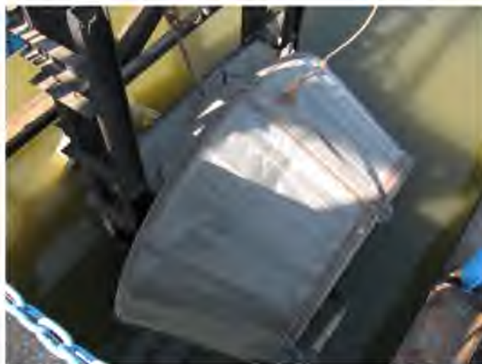
Рисунок 4.12 – Рыбозащитное устройство в форме усеченного конуса (РОП)
